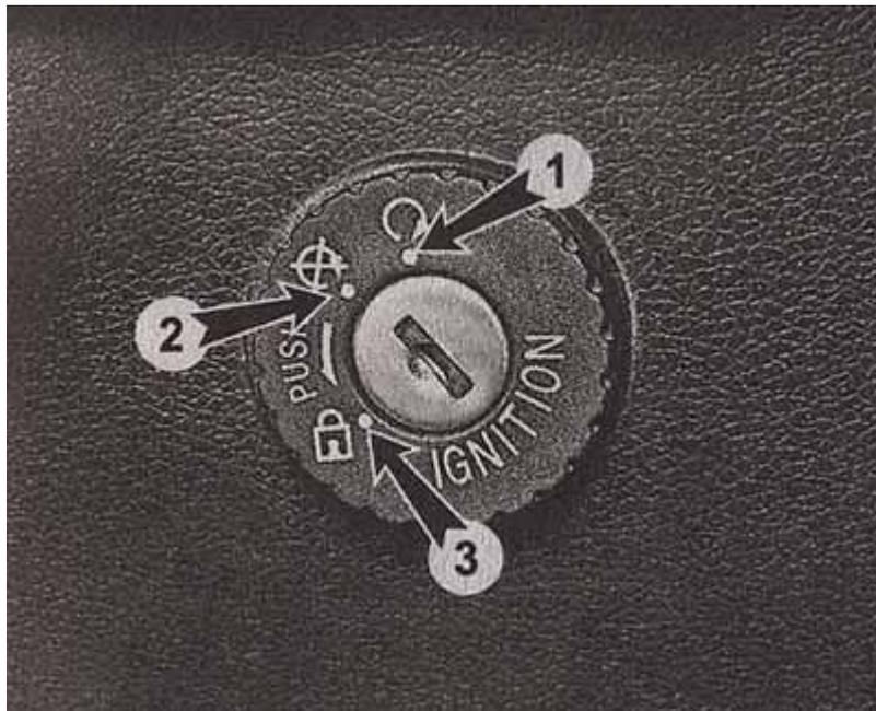
1. ON — все системы включены, рулевая колонка разблокирована, ключ нельзя вынуть из замка зажигания;
