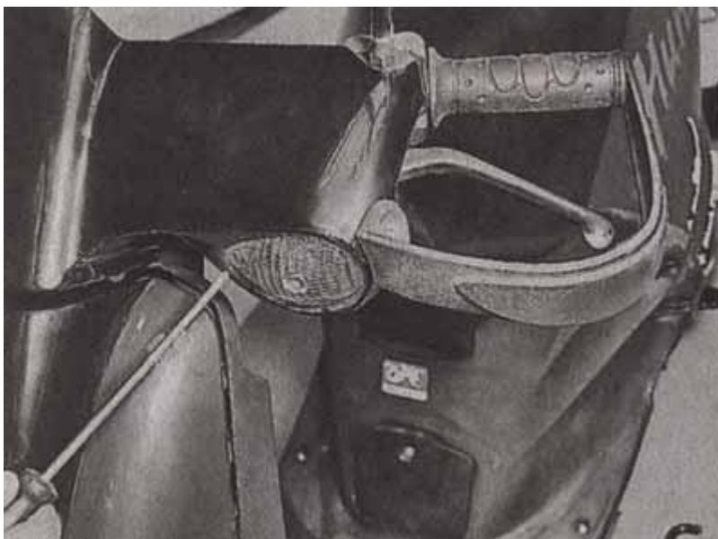
2. Снимаем рассеиватель.
