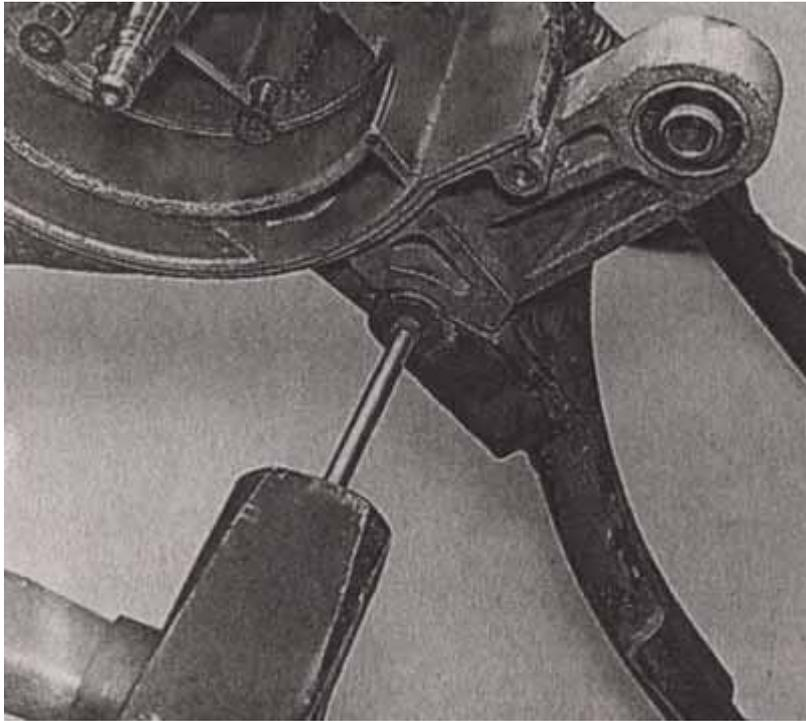
Снимаем подставку с картера, одновременно снимаем пружину.
