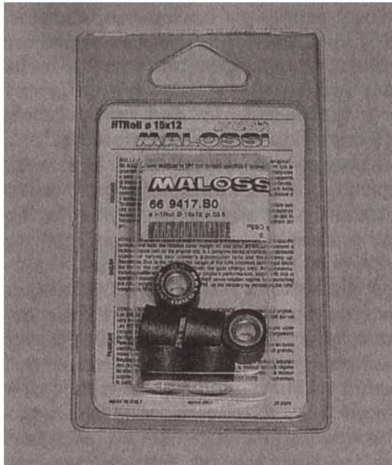
Настройка вариатора осуществляется при помощи замены центробежных роликов-грузиков.
