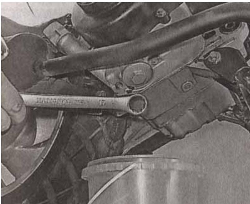
3. При наличии в сетке отложений, необходимо промыть ее в бензине или растворителе перед установкой на место. Полностью слив масло (в двигателях 50-кубовых скутеров его объем обычно около 1 л), заворачиваем пробку на место, предварительно установив фильтрующую сетку.
