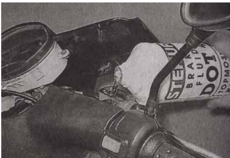
8. Для ускорения прокачки тормозной системы рекомендуется несколько раз до упора нажать на тормозной рычаг. Когда из прокачного штуцера пойдет свежая жидкость, штуцер необходимо затянуть. После затягивания прокачного штуцера, несколько раз нажимаем на тормозной рычаг, до появления сопротивления нажатию.
