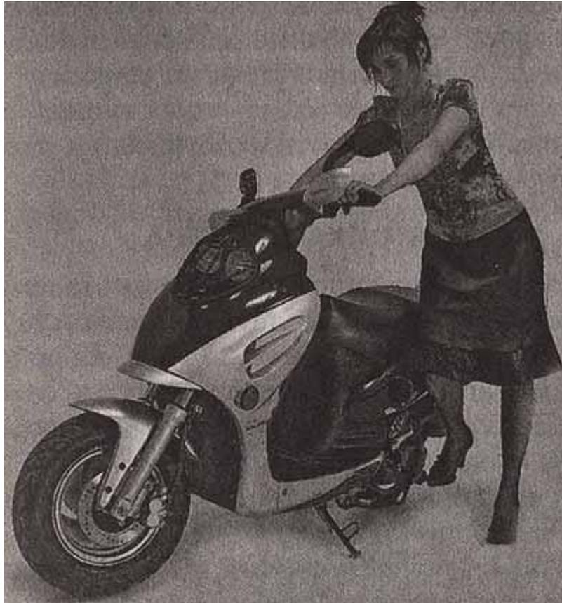
Управление скоростью осуществляется простым поворотом ручки «газа». При повороте ее на себя увеличиваются обороты коленчатого вала, соответственно увеличивается скорость скутера. При отпуске ручки «газа», игла главной дозирующей системы возвращается в исходное положение, обороты коленчатого вала опускаются до уровня оборотов холостого хода, скутер же продолжает двигаться по инерции без существенного сброса скорости.
