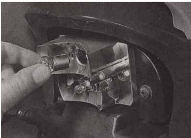
4. Заменяем лампу габаритного сигнала на аналогичную по номиналу.
