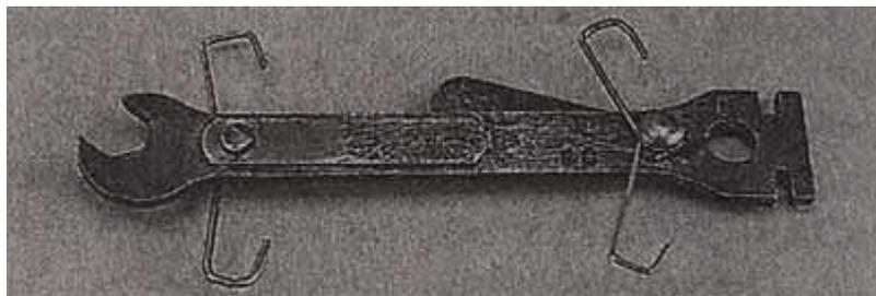
**11. Набор плоских щупов для измерения зазоров при оценке технического состояния агрегатов.**
