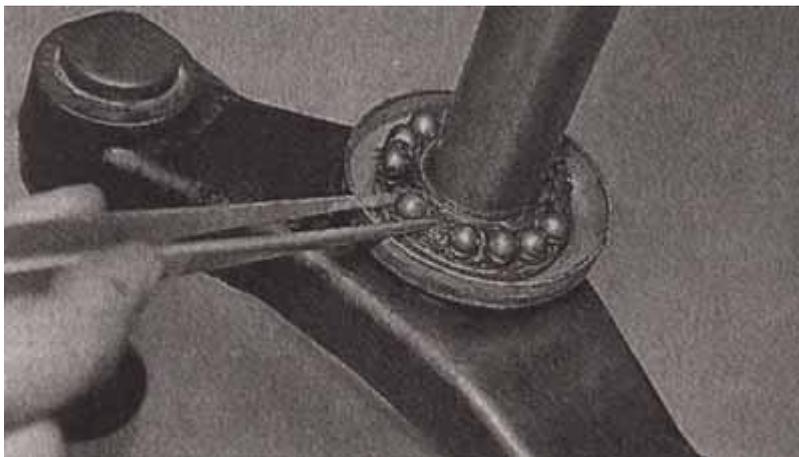
В рулевой колонке часто применяются радиально-упорные бессепараторные («насыпные») подшипники
