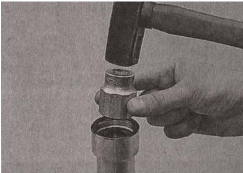
2. Установку остальных деталей вилки производим в обратной последовательности, залив требуемый объем масла, рекомендованного производителем согласно инструкции к скутеру.
