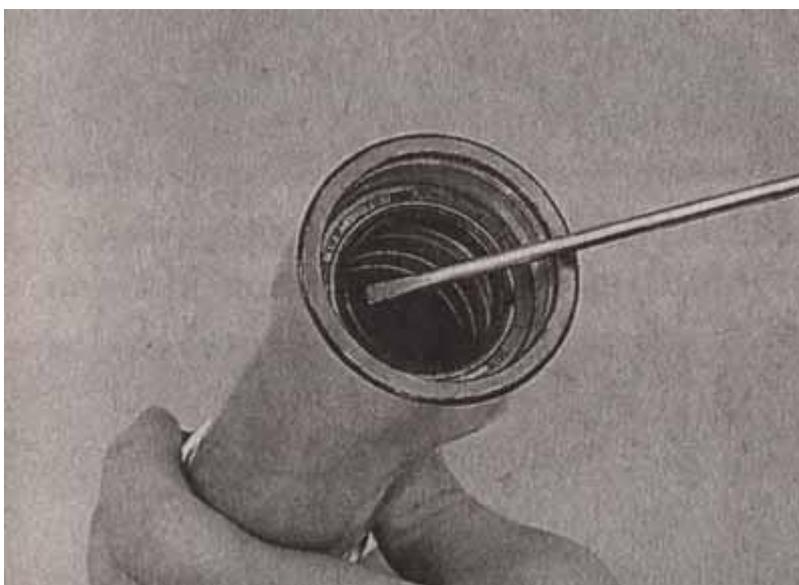
Промываем все детали вилки в керосине и осматриваем их. Если заметны сильные повреждения или износ хромового покрытия неподвижных труб, необходимо заменить детали или вилку в сборе.
