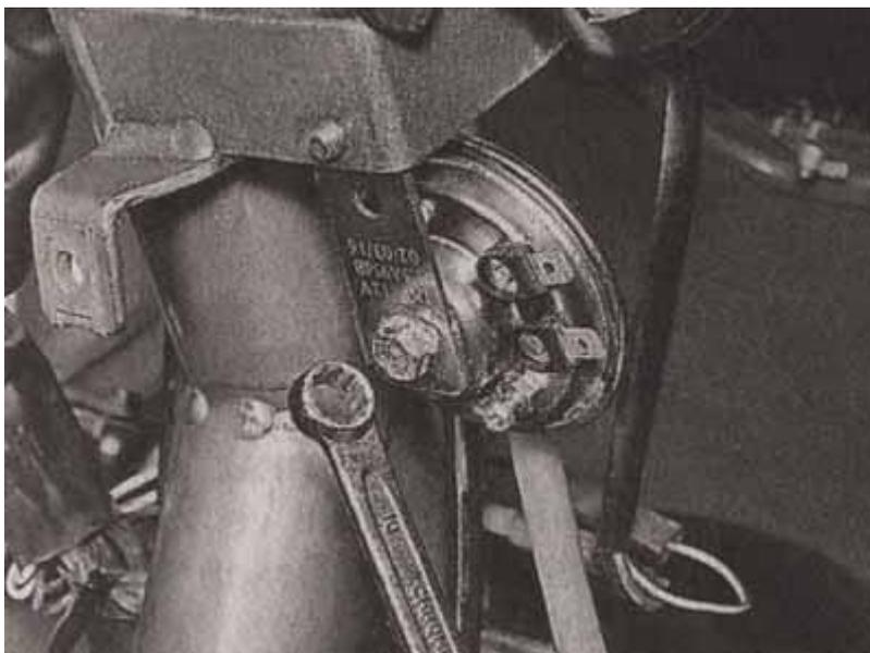
3. Снимаем звуковой сигнал.
