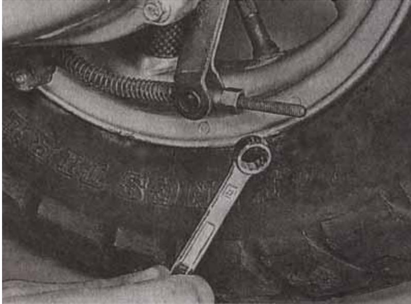
При износе тормозных колодок до предела, их необходимо заменить (см. [«Колодки барабанного тормозного механизма — замена»](#)).
