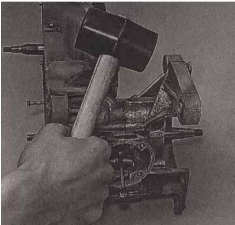
30. Снимаем малую половину картера вместе с шестерней привода маслонасоса.
