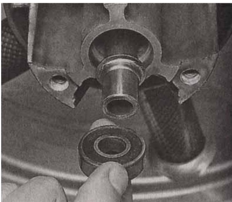
3. Оставшийся подшипник демонтируем также, как и снятый, при помощи I выколотки и молотка.
