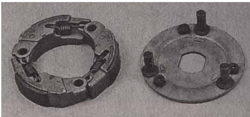
15. Извлекаем пружины, соединяющие колодки и разбираем пакет колодок.
