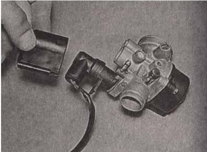
13. Отворачиваем два винта, крепящие пусковой обогатитель.
