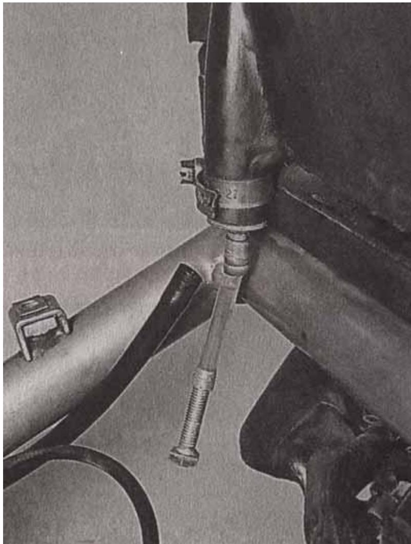
5. Пассатизами снимаем пружинный хомут и снимаем шланг подачи масла со штуцера маслобака.
