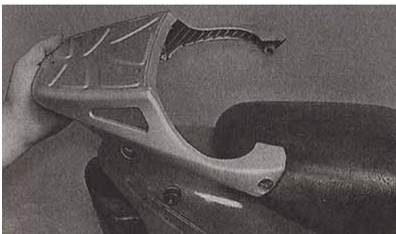
3. Отворачиваем болт крепления пластикового «уголка» под поликом скутера.
