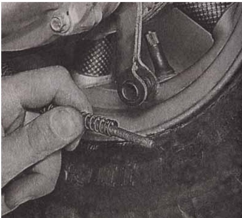
12. Отворачиваем хомут оплетки троса тормоза от картера силового агрегата и освобождаем трос.
