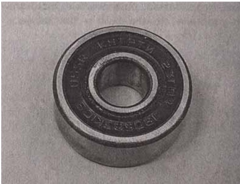
Колесные подшипники обычно выполняются закрытыми, чтобы исключить их обслуживание, а также попадание грязи и воды внутрь
