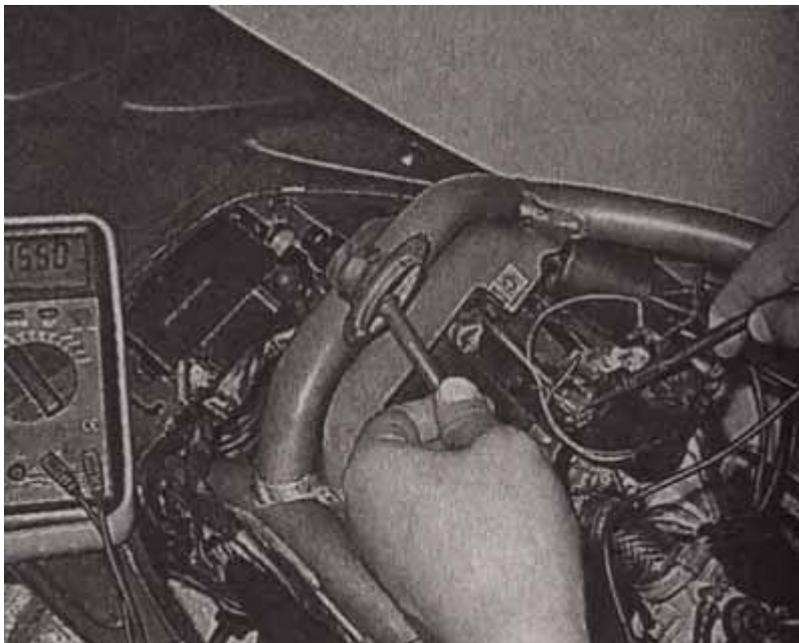
3. Сопротивление вторичной обмотки проверяется путем измерения сопротивления между колпачком свечи и одним из выводов первичной обмотки.
