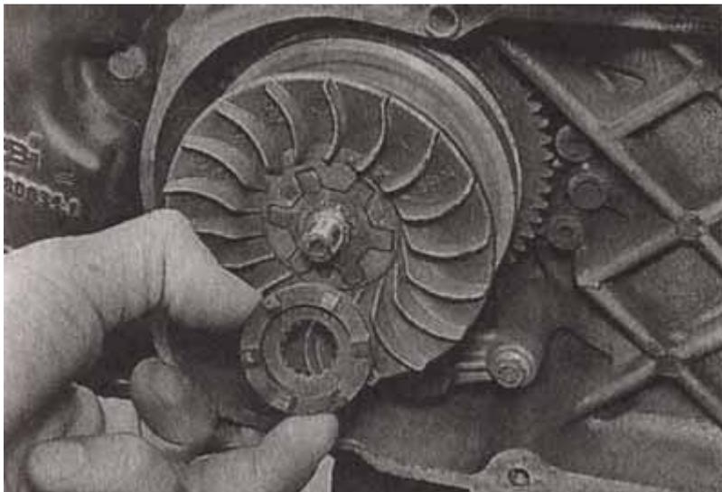
4. Снимаем фиксирующую шайбу ведущего шкива.
