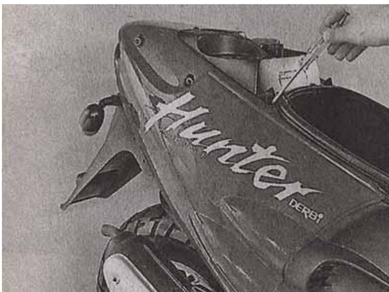
6. Отворачиваем болты крепления, находящиеся между ребрами воздухозаборника.
