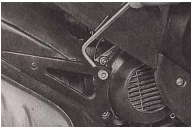
3. Снимаем глушитель и стальную фиксирующую пластину.
