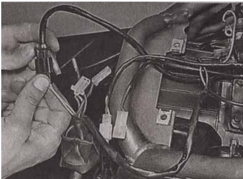
8. Отсоединяем клеммы от катушки зажигания.
