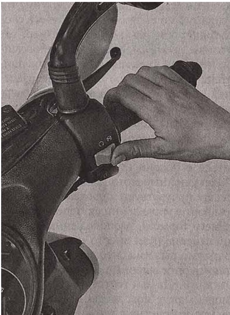
выжать левый тормозной рычаг и на 1—2 секунды нажать кнопку стартера.
