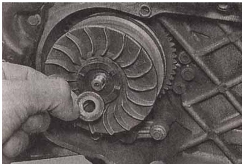
3. Снимаем с вала втулку храпового механизма кикстартера.
