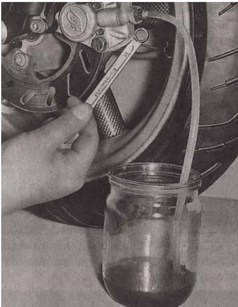
7. После начала стравливания тормозной жидкости из системы, необходимо постоянно доливать в бачок свежую жидкость, во избежание попадания в систему воздуха.
