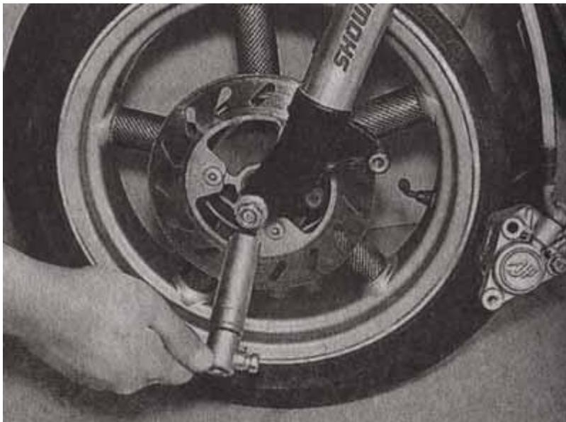
6. Удерживая (при необходимости) ось рожковым ключом, торцовым или накидным ключом отворачиваем гайку оси.
