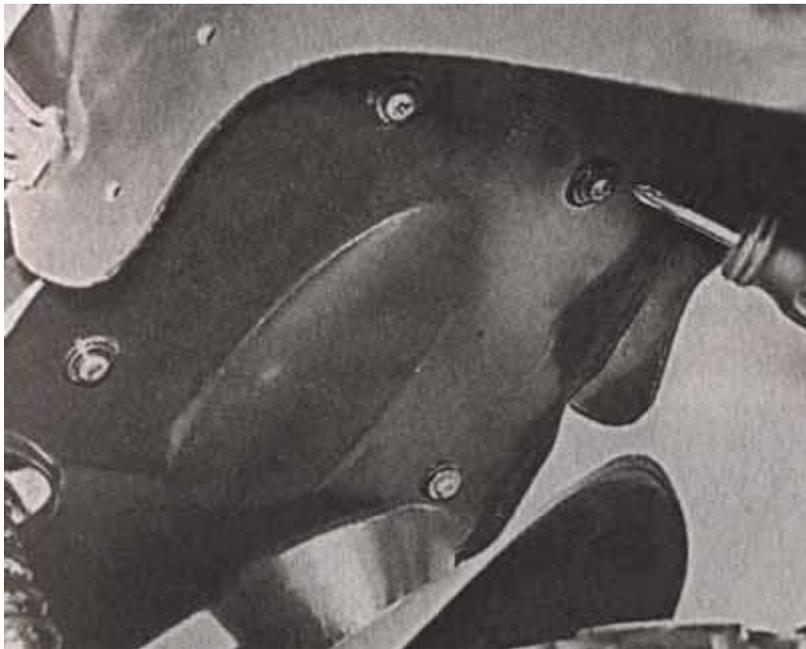
8. Снимаем подкрылок, сдвигая его вперед и вниз.
