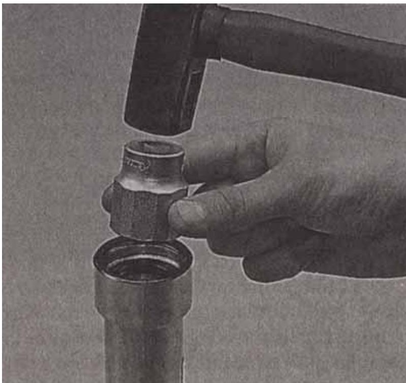
9. Устанавливаем торцовую головку на сальник точно по центру, без смещений и легкими ударами молотка осаживаем сальник в гнезде.
