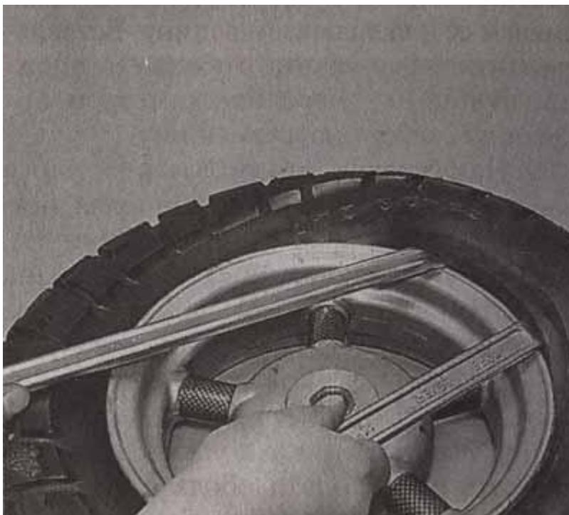
5. Когда лопатки окажутся разведенными примерно на треть обода, отгибаем край покрышки по всей длине.
