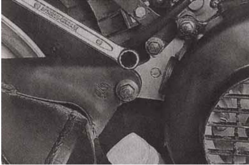
10. Снимаем кожух охлаждения цилиндра (см. [Двухтактный двигатель — разборка и сборка](#)).
