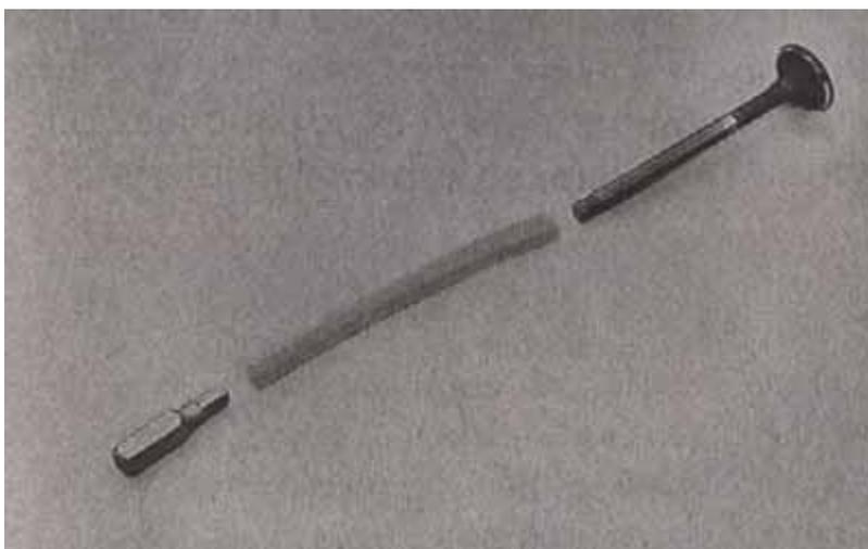
3. Наносим на рабочую кромку клапана притирочную пасту.
