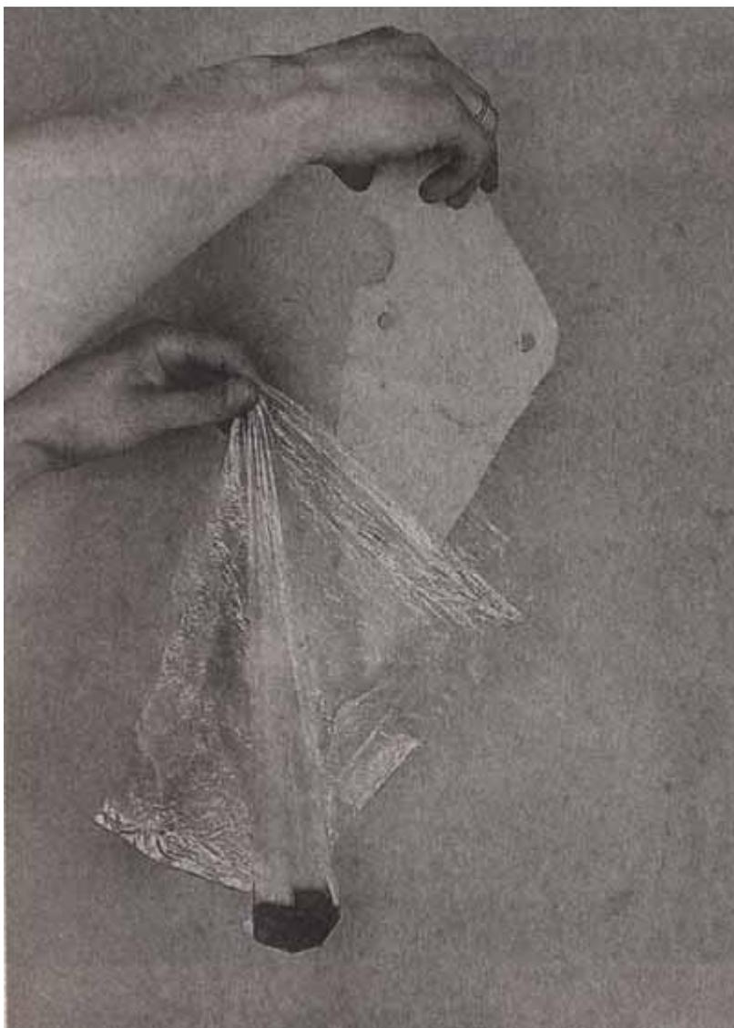
5. Завязываем его и мнем в руках до полного впитывания масла в фильтрующий элемент.
