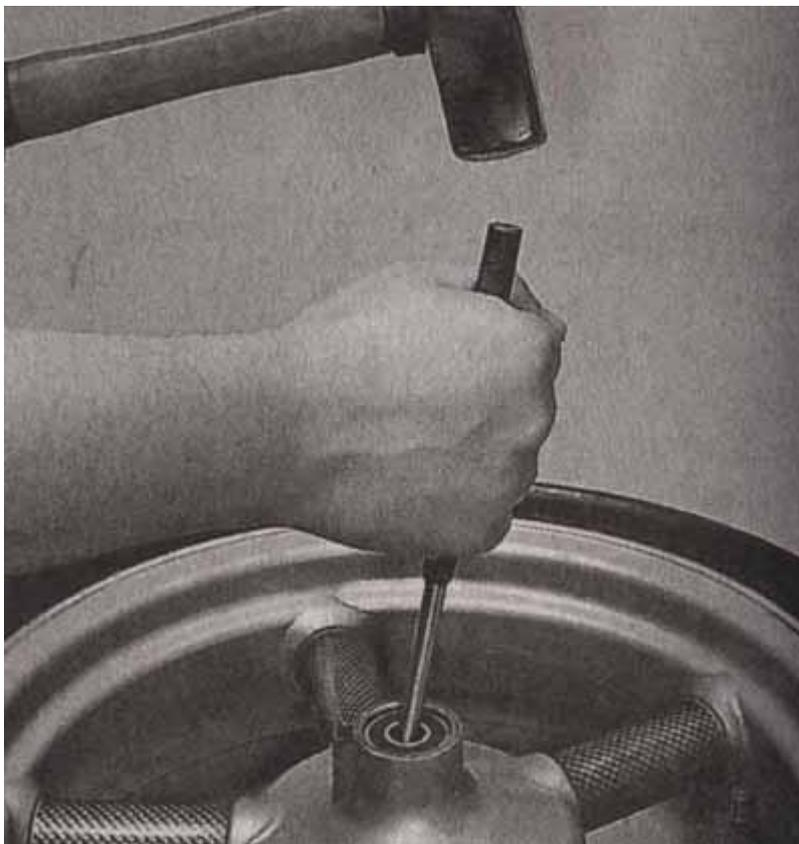
2. Извлекаем один из подшипников ступицы вместе с распорной втулкой.
